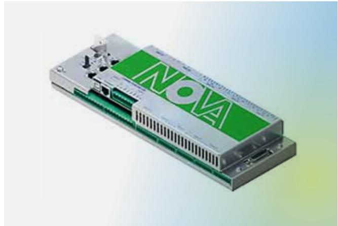
Mit dem NOVA DDC-Steuer- und Regelsystem steht zur Regelung der AqualLine-Klimageräte modernste Steuertechnologie mit vielen Komfortfunktionen zur Verfügung. Sie ermöglicht sowohl die Fernüberwachung und -bedienung der Anlage via Modem, wie auch die Anbindung an die Betriebsdatenauswertung. Die Ankoppelung an bestehende Gebäudeleitsysteme ist optional jederzeit möglich.
